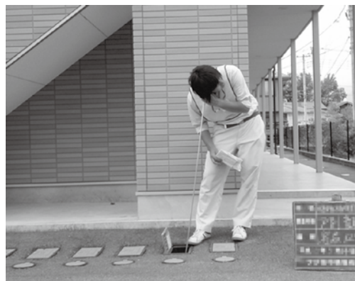
（参考）漏水調査イメージ写真
