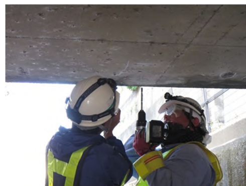
〔 図 ドリル法 作業状況例 〕
